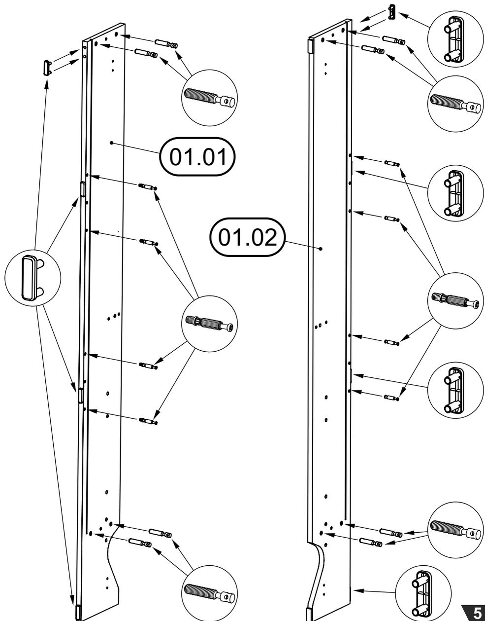
Установить два захвата на поперечную царгу 14 с помощью восьми саморезов  $\text{Ø}4 \times 16$  как показано. В гайки поперечных царг 01.03 и 14 на 4-5 оборотов ввернуть два винта стяжки кровати. В отверстия на торцевых кромках с двух сторон установить шканты  $8 \times 30$ .
