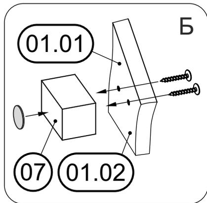
Установить кронштейны подъемного механизма без газовых лифтов на продольные царги правую 01 и левую 02 и наживить при помощи гаек со сферической головкой и винтов М6х20. Под головки винтов М6х20 подложить увеличенные шайбы 6. Обратите внимание, что гайка должна располагаться внутри ниши.
