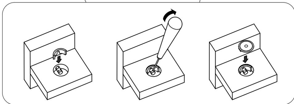
Порядок сборки сегментных стяжек: в отверстия поперечных царг 03 вставить сегменты и с помощью шила завернуть винты до упора. В отверстия вставить заглушки.
