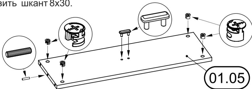
Присоединить царгу поперечную 01.03 к царге продольной левой 01.01, совместив винты сегментной стяжки и шкант с отверстиями сопрягаемых деталей. Зафиксировать детали при помощи сегментных стяжек.
