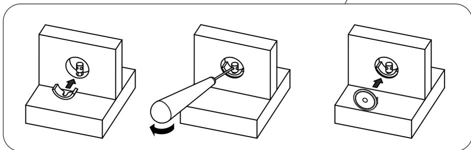
Порядок сборки сегментных стяжек: в отверстия царги 03 вставить сегменты и с помощью шила завернуть винты до упора. В отверстия вставить заглушки.
