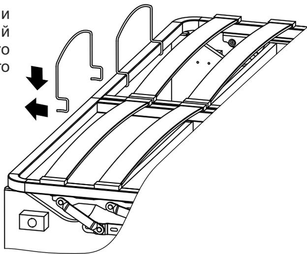
Поднять ортопедическое основание и установить газовые лифты **цилиндром вверх** на сферические опоры левого и правого кронштейнов подъемного механизма до щелчка.
