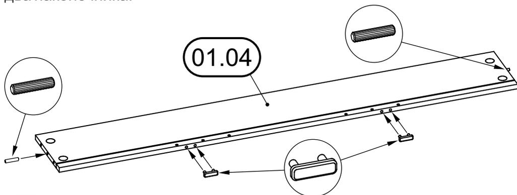
Присоединить перегородку 01.04 к царге поперечной 01.03, совместив винты сегментной стяжки и шкант с отверстиями сопрягаемых деталей, при этом дно основания 06 должно войти в паз перегородки. Зафиксировать детали при помощи сегментных стяжек.
