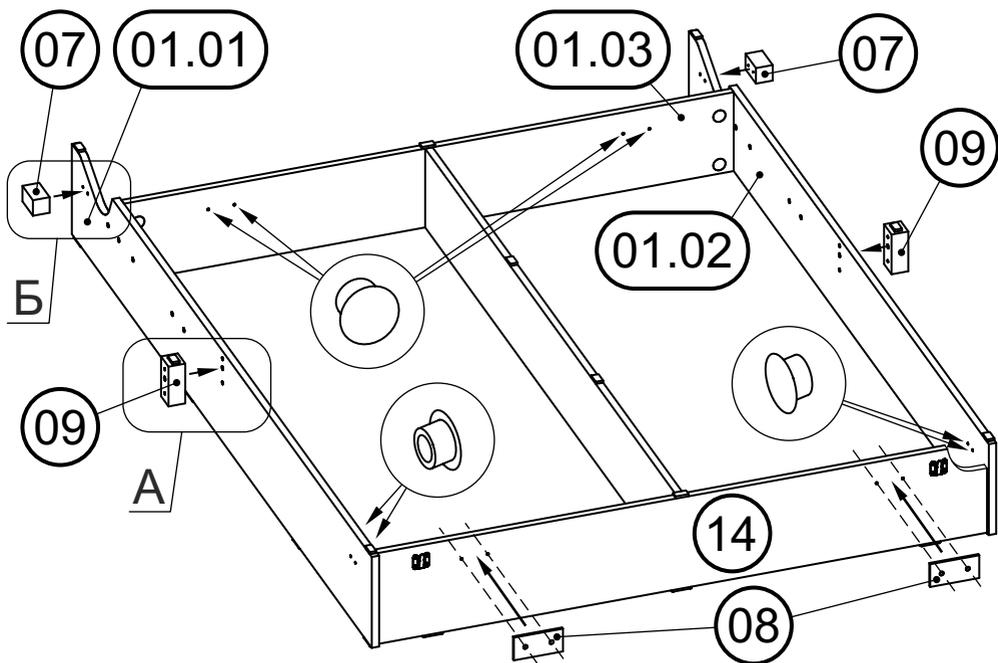
Снять защитную пленку с двусторонней клеящей ленты на накладках 08. Наклеить накладки 08 на царгу поперечную 14, совместив отверстия на соединяемых деталях. На поперечной царге 01.03, на продольных царгах 01.01 и 01.02 неиспользуемые отверстия изнутри основания закрыть заглушками  $\varnothing 5$  мм.
