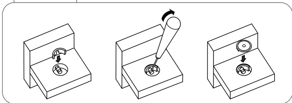
Порядок сборки сегментных стяжек: в отверстия перегородки 04 и поперечной царги 03 вставить сегменты и с помощью шила завернуть винты до упора. В отверстия вставить заглушки.
