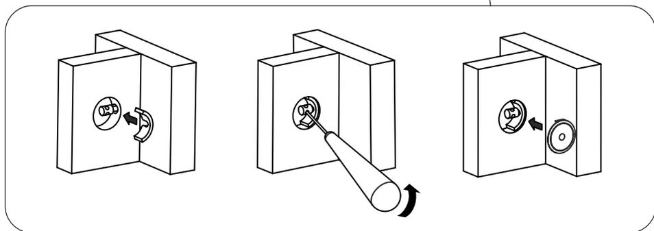
Порядок сборки сегментных стяжек: в отверстия боковых царг 03 вставить сегменты и с помощью шила завернуть винты до упора. В отверстия вставить заглушки.
