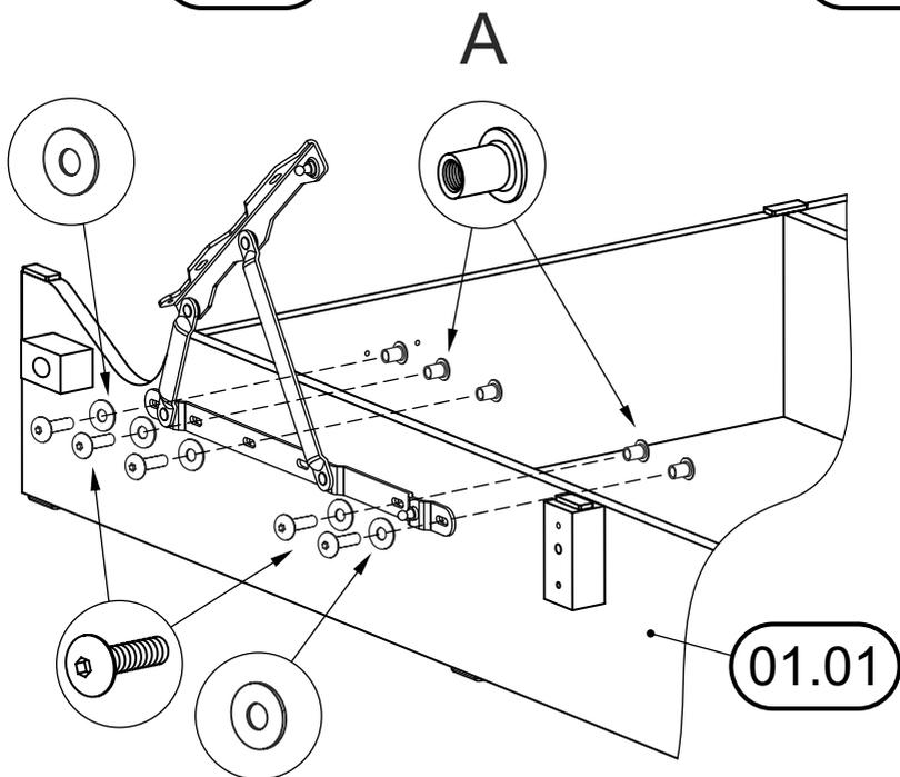
На кронштейны подъемного механизма установить и наживить при помощи болтов М8х45, гаек самоотпрягающихся М8 и шайб металлических. Опустить ортопедическое основание на каркас и выровнять основание относительно продольных и поперечных царг каркаса так, чтобы край основания и поперечная царга были в одной плоскости. Затянуть гайки при помощи ключей на 13 до упора.
